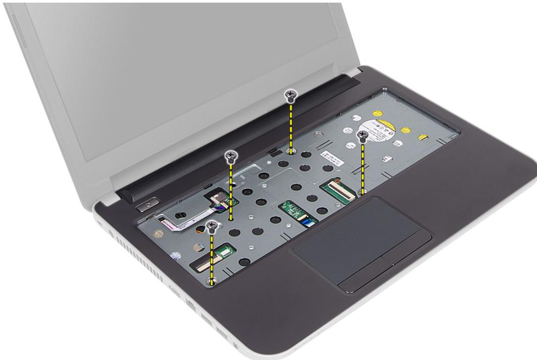
5. Desligue o painel tátil e o cabo do botão de ligar/desligar da placa de sistema.
