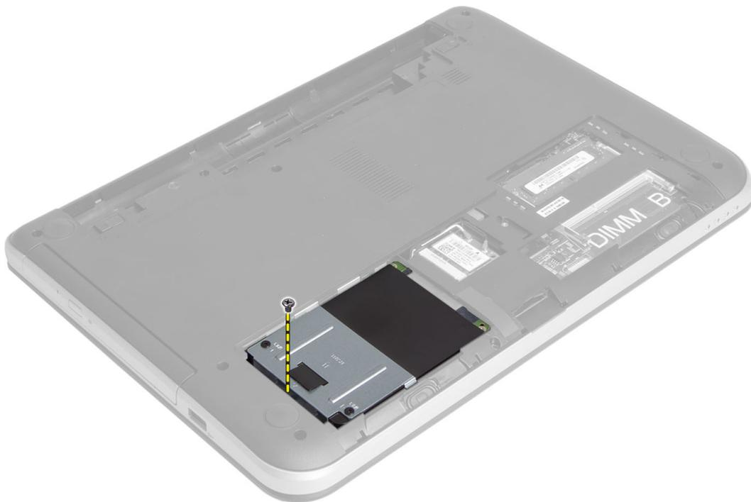
4. Deslize a unidade de disco rígido na direcção mostrada e levante a patilha para retirá-la do computador.
