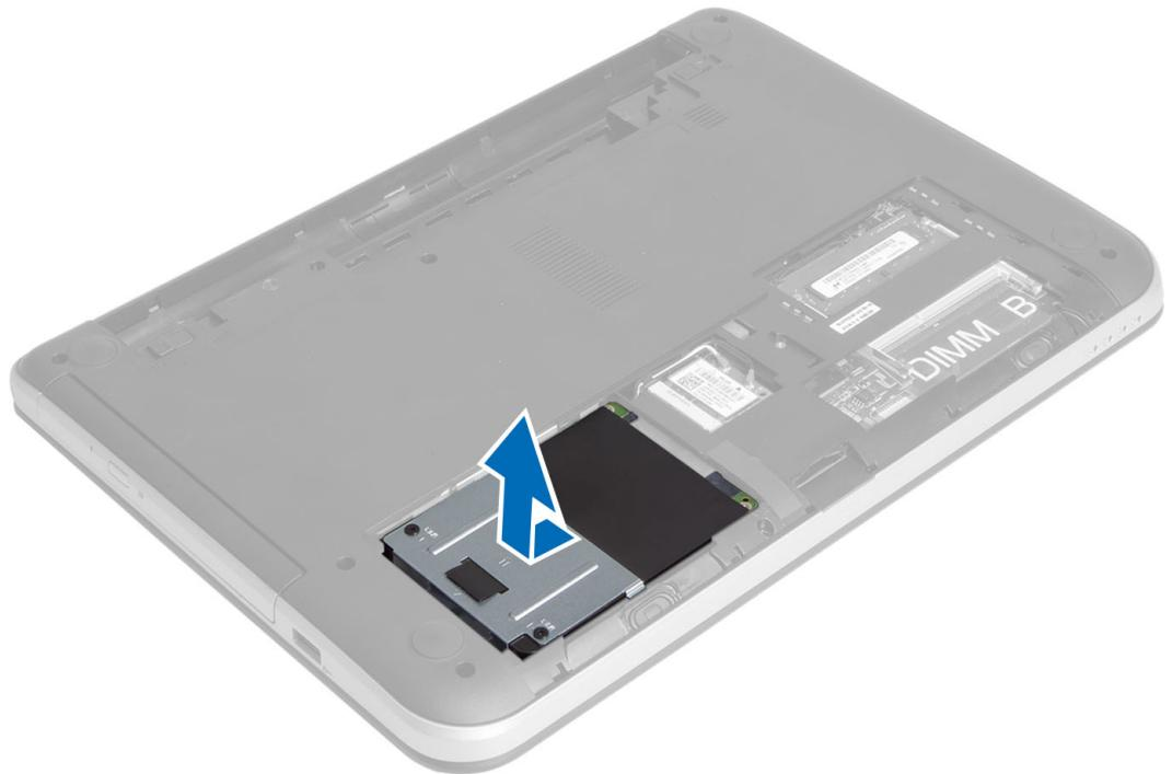
5. Retire o parafuso que fixa o suporte da unidade de disco rígido à respectiva unidade e retire-a.
